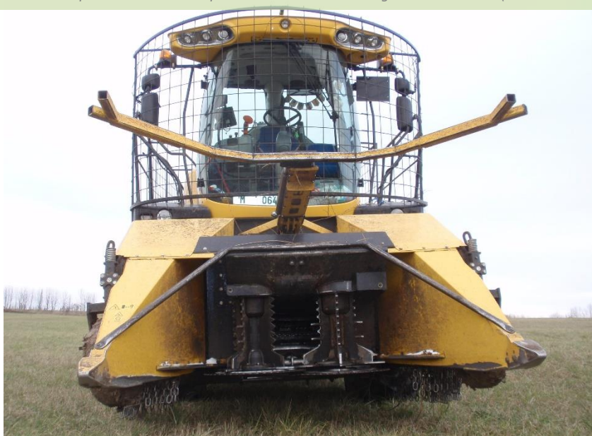
Faucheuse-déchiquteuse sur tracteur pour la récolte d'une seule ligne d'arbres taillés (diamètre max.15-20cm)
