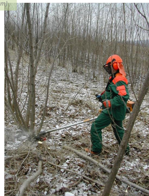
Débroussailleuse utilisée pour la récolte manuelle en 2 phases de la ligne / bande de taillis (diamètre max.10-15cm)
