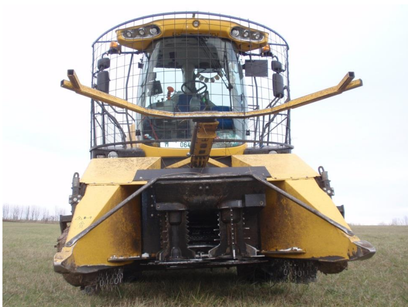
Cosechadora de forraje con un cabezal de corte especial para árboles con copas (diam. máx. 10-15 cm).
