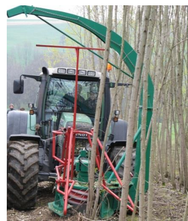
Segadora-trituradora en el tractor para cosechar una sola línea de árboles recepados (diam. máx. 15-20 cm).
