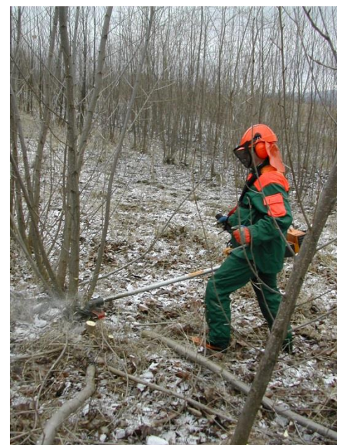
Cortadora de arbustos utilizada para la cosecha manual en dos fases de la línea/cinta de árboles recepados (diam. máx. 10-15 cm).
